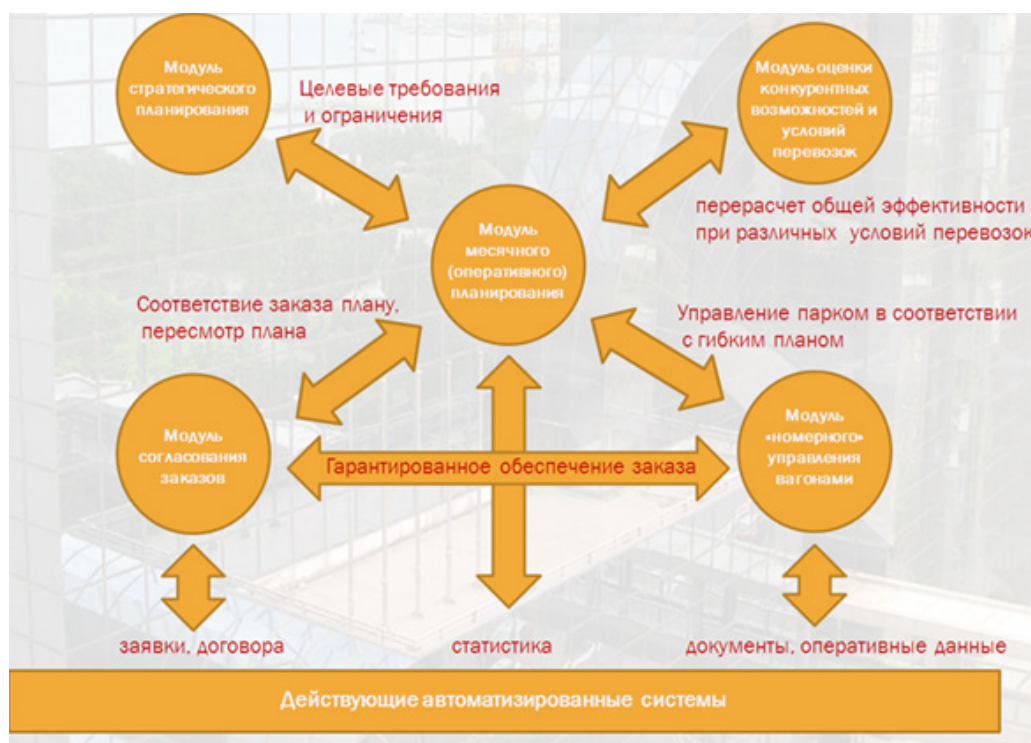
Рисунок 2 – Структура управляющей автоматизированной системы
