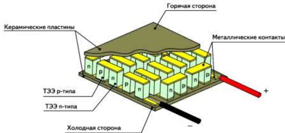
Рисунок 3 – Термоэлектрический преобразователь
