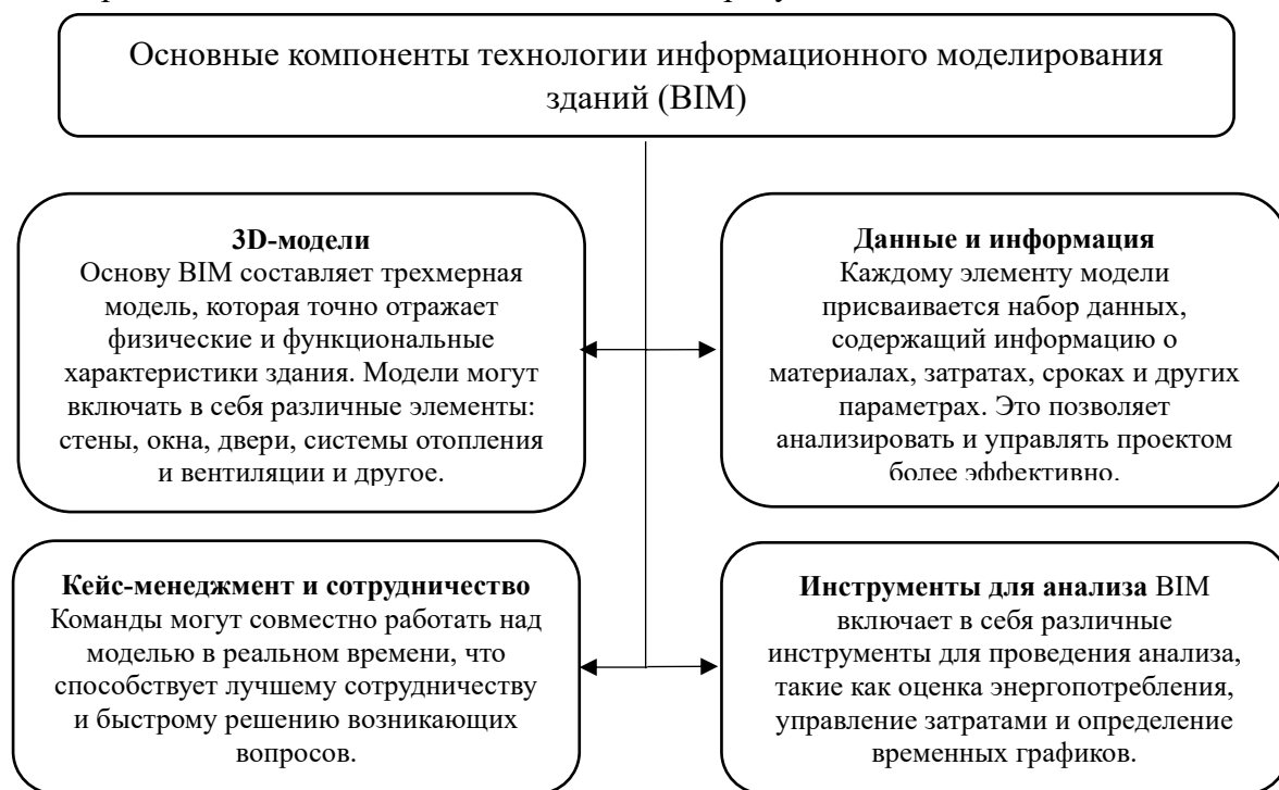
Рисунок 1 – Основные компоненты технологии BIM
