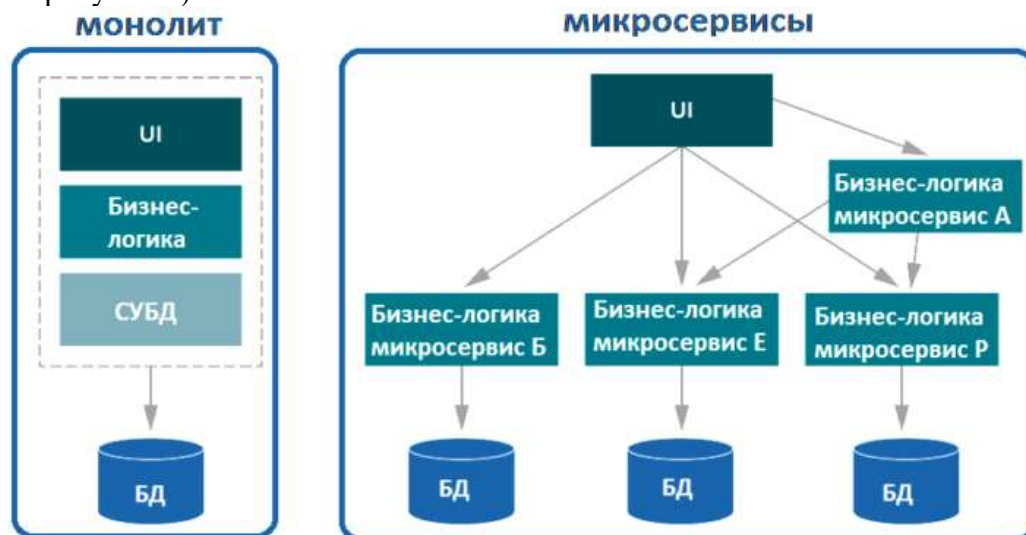
Рисунок 1 – Представление монолита и микросервисной архитектуры
