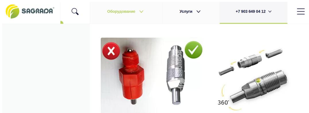
Рисунок 3 – Ниппель с широким штифтом и углом срабатывания 360° [6]
