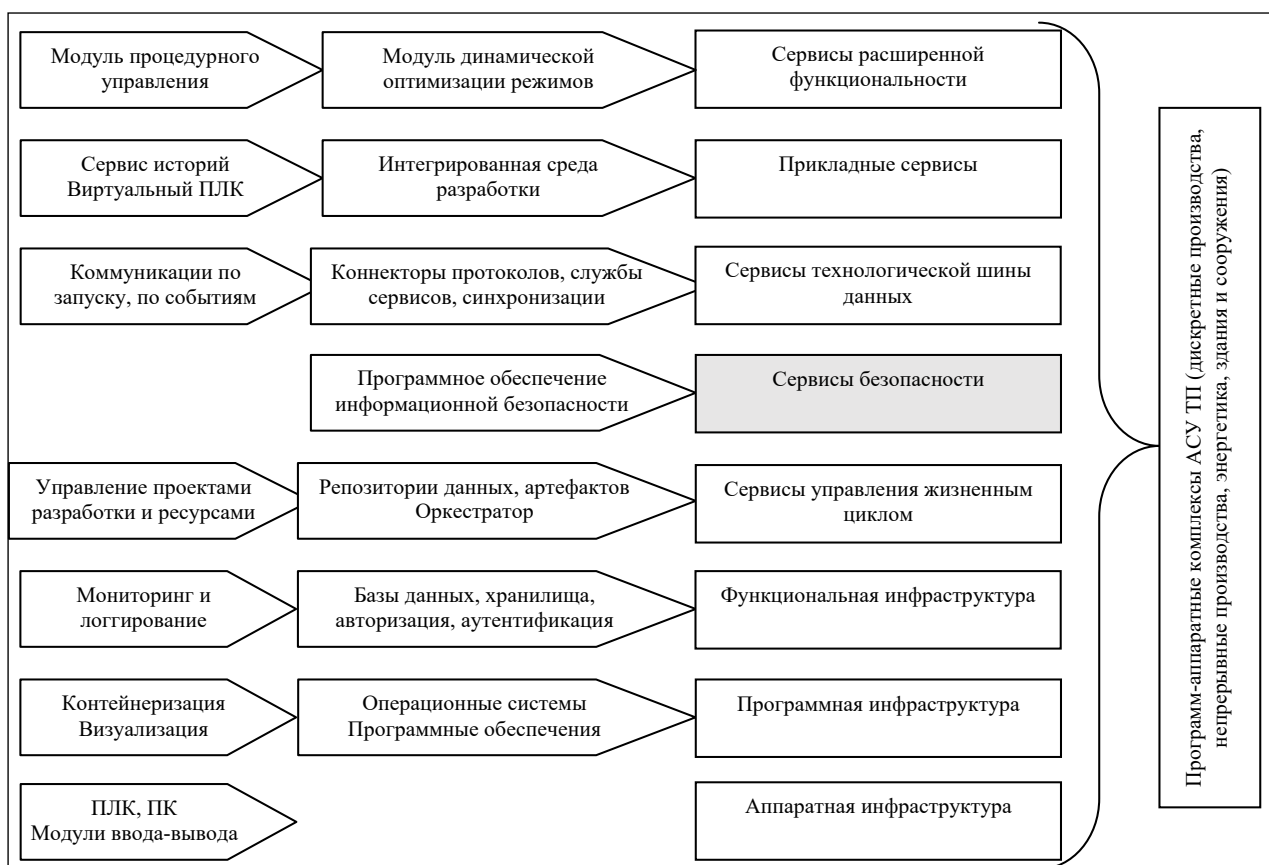
Рисунок 3 – Многоуровневая архитектура открытой АСУ ТП O-PAS [10; 11]
