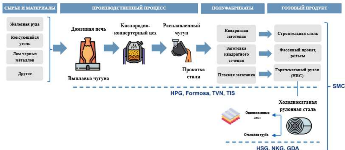
Диаграмма 5: Процесс производства стали и стальная продукция
