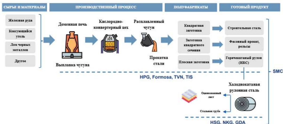
Диаграмма 5: Процесс производства стали и стальная продукция
